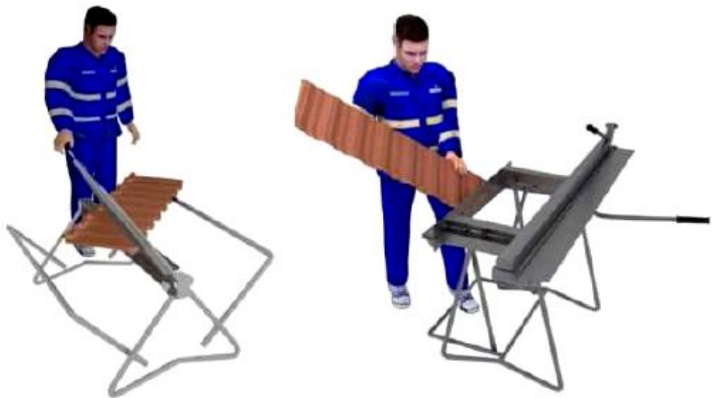
Strihanie a ohýbanie šablón pre nárožie pomocou pákových nožníc a nožnej ohýbačky
